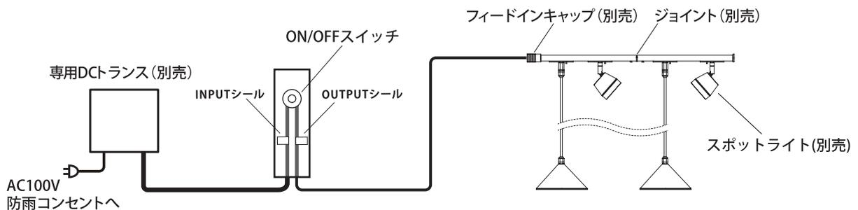
コンクリート、モルタルなどへ配線する場合は、電源コードを電線保護管(別売)に必ず通し、不乾性パテ(別売)で止水処理を行い、メンテナンスができるように施工してください。
